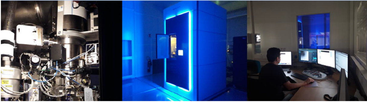
Légende : Vue de l'intérieur, de l'extérieur et de la salle de contrôle du cryo-microscope Titan Krios G4 CM02 © IBS - EN
