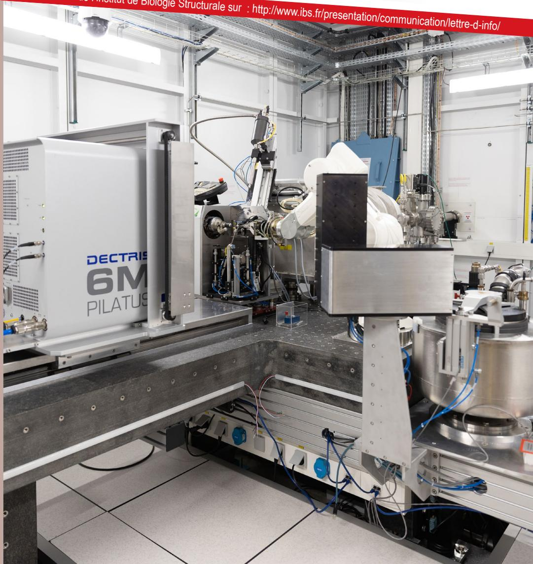
Nouvelle ligne de lumière FIP2 à l'ESRF : cabine d'expérience avec détecteur, diffractomètre, bras robot chargeur d'échantillons et dewar de stockage © C. Berzin (IBS/CEA-CNRS-UGA)
