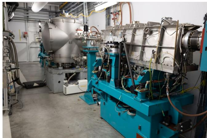
Intérieur de la cabane optique de la ligne de lumière FIP2 : enceintes du monochromateur (à gauche) et du premier miroir de focalisation (à droite)
